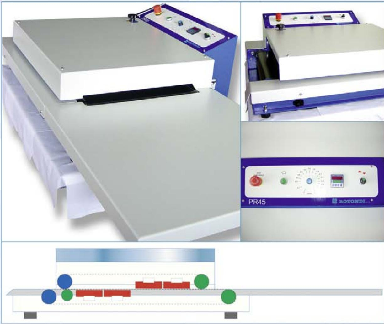
Adesivatrice compatta per accoppiamento tessuti nel settore abbigliamento e capospalla.
