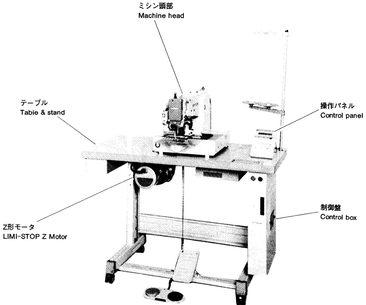
注1：モータ部分は三菱リミストップZクラッチ：モータの部品カタログ(P-007B)を参照ください。
