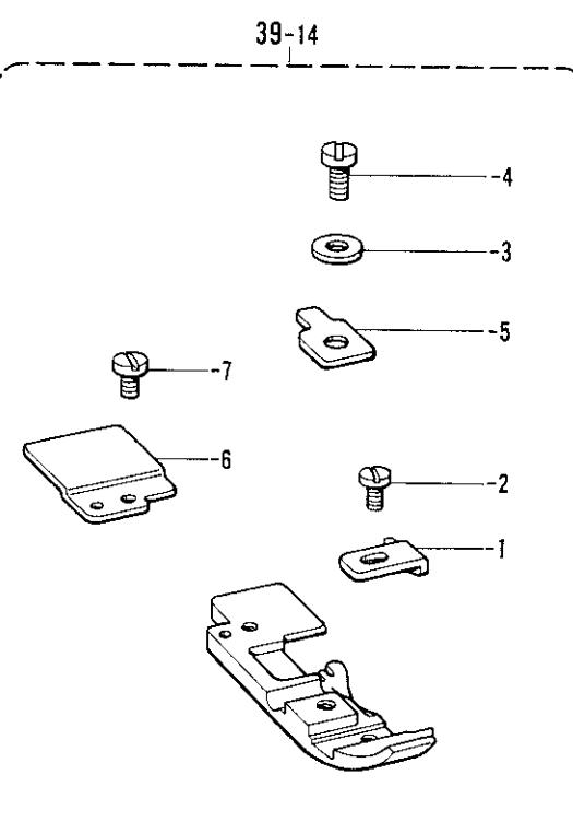
E. 押工関係/Presser foot mechanism/Stoffdrückerfuß/
