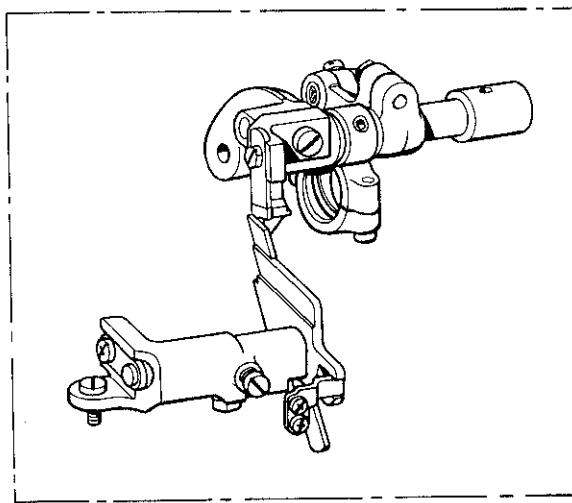
G. 上メス・下メス関係/Knife mechanism / Messer / Mécanisme du couteau / Mecanismo del cuchilla
