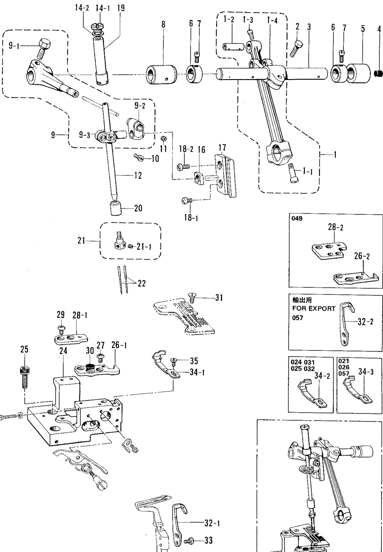
D. 針棒関係 / Needle bar mechanism / Nadelstangenvorrichtung /
