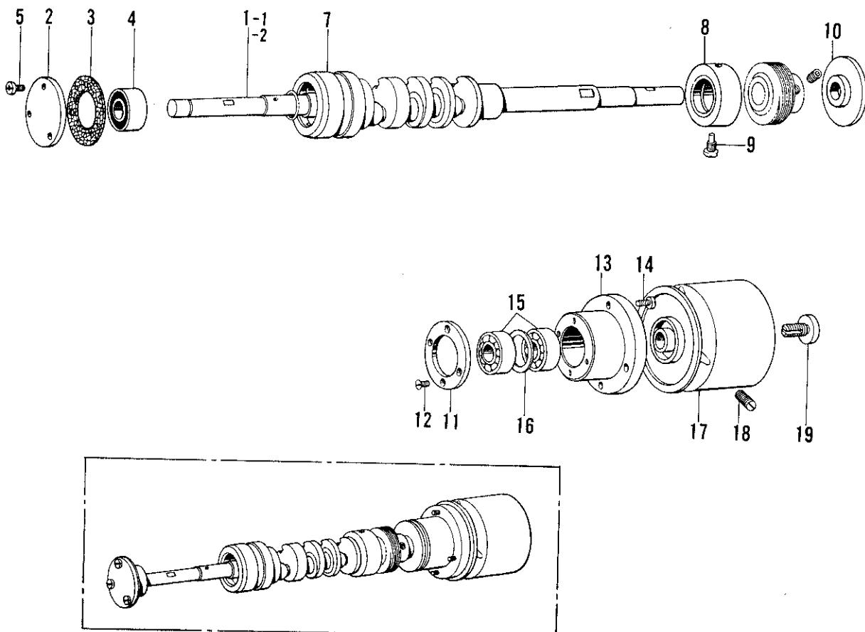
C. 針冷却装置/Needle cooler/Nadelkühlungsvorrichtung/
